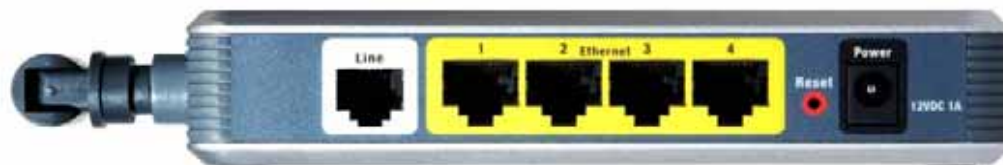
Figura 3-1: Porte e pulsante Reset (Ripristino) sul pannello laterale
