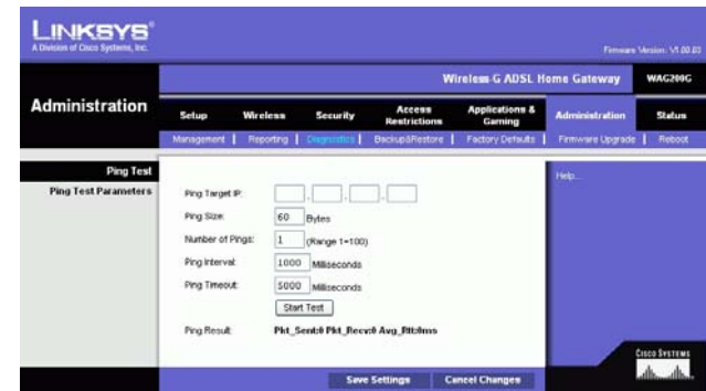
Bild 5-36: Ping Test (Ping-test)
