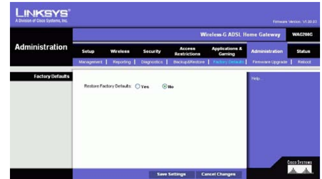
Figura 5-38: Factory Defaults (Parámetros predeterminados de fábrica)
